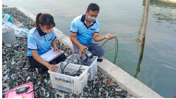
รูปที่ 3 การตรวจวัดปัจจัยคุณภาพน้ำเบื้องต้น และเก็บตัวอย่างน้ำทะเล บริเวณปากแม่น้ำบางตะบูน จังหวัดเพชรบุรี
