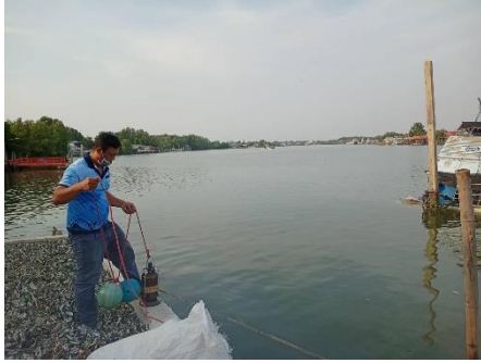
รูปที่ 3 การตรวจวัดปัจจัยคุณภาพน้ำเบื้องต้น และเก็บตัวอย่างน้ำทะเล บริเวณปากแม่น้ำบางตะบูน จังหวัดเพชรบุรี
